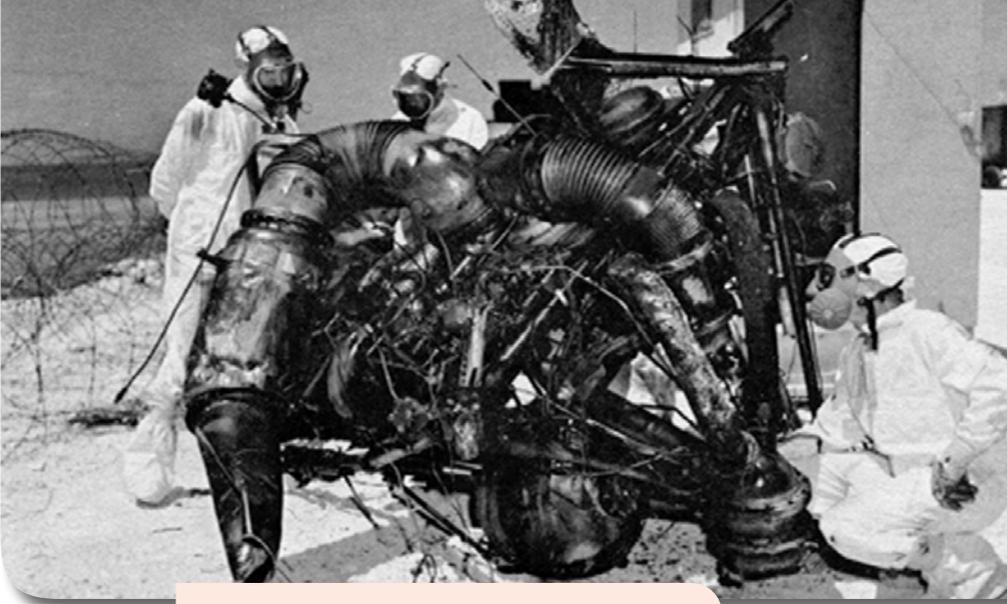
**Spezialisten begutachten die radioaktiv verstrahlten Überreste des zuvor zerstörten Thor-Triebwerks.**
