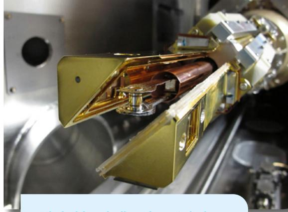
*Die beiden dreikantigen Schalen geben die gekühlte Kapsel mit Brennstoff frei, die kurz darauf von Lasern beschossen wird.*
