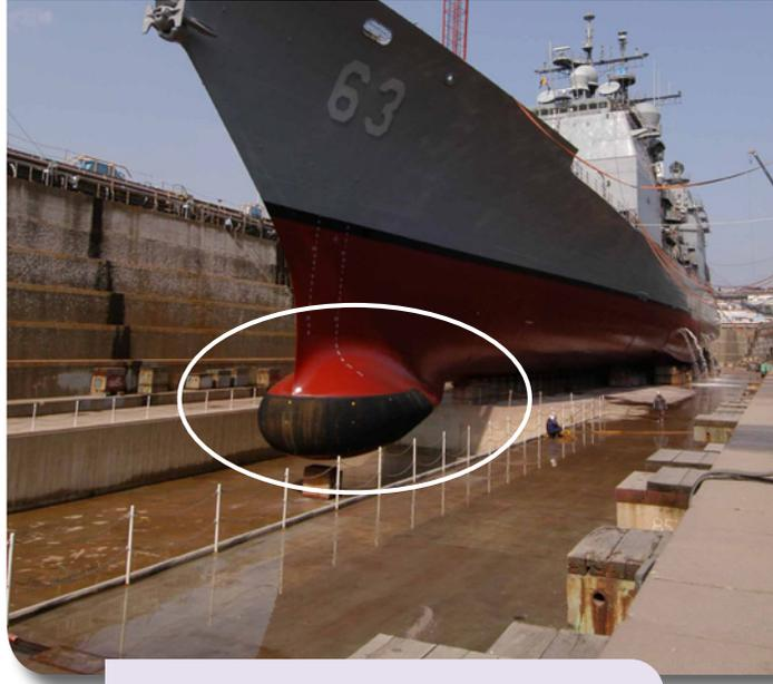
*So sieht ein Sonargerät am Schiff aus.*
