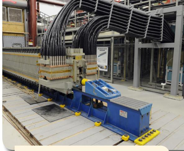
*Die elektrischen Zuleitungen einer Railgun: Die benötigten Stromstärken sind etwa zehnmal höher als die eines Blitzes. Um dieser Belastung standzuhalten, braucht es sehr viele Kabel.*
