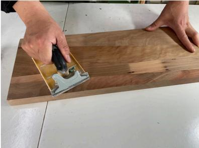
**1** Zuerst wird das Holzbrett geschliffen und poliert. Die kleinste Unebenheit wirkt sich auf das spätere Resultat aus. Hat das Holzbrett einen »Fehler« und fällt dieser genau auf die Stelle, an der ein wichtiges Bildelement erscheinen soll, kann das Brett nicht mehr verwendet werden.
