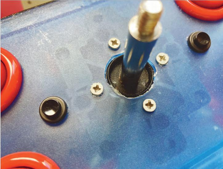
Abbildung 5.22 Wenn du alle Löcher gebohrt hast, kannst du den Joystick festschrauben.
